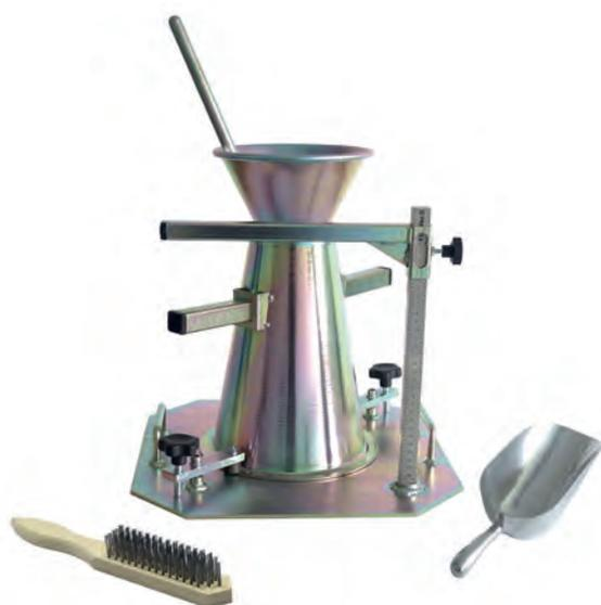
**10.0015 NF EN 12350-2****CÔNE D'ABRAMS AVEC POTENCE EN ACIER**
