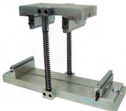
**50.3353 ASTM C469****EXTENSOMÈTRE LONGITUDINAL****Mesure du module d'élasticité en compression simple avec calcul du coefficient de poisson**
