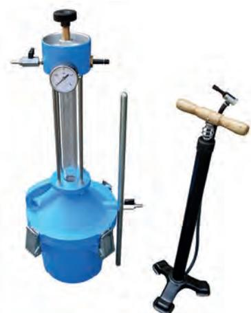
**10.0600 NF EN 12 350-7 - ISO 1920-2****AÉROMÈTRE À BÉTON 5 L**
