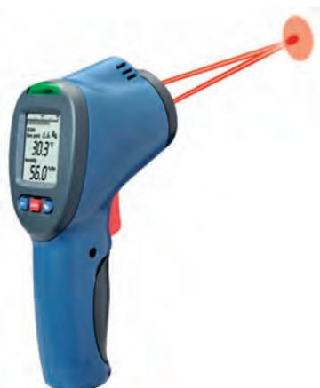
**03.0400 NF EN 12697-13****THERMO-HYGROMÈTRE INFRAROUGE À VISÉE LASER****Permet de mesurer la température des mélanges bitumeux**
