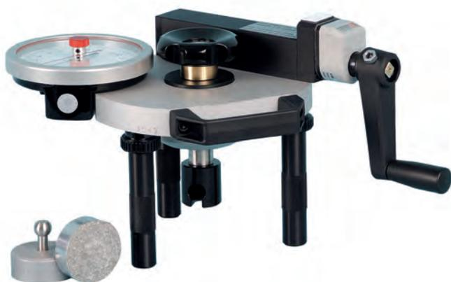
**DYNAMOMÈTRE DE TRACTION ANALOGIQUE****Destiné aux essais d'adhérence des matériaux**
